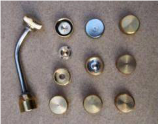
Vòi phun nón rộng. Chú ý: có rất nhiều kích cỡ lỗ - ảnh hưởng đến tốc độ vòi phun.
